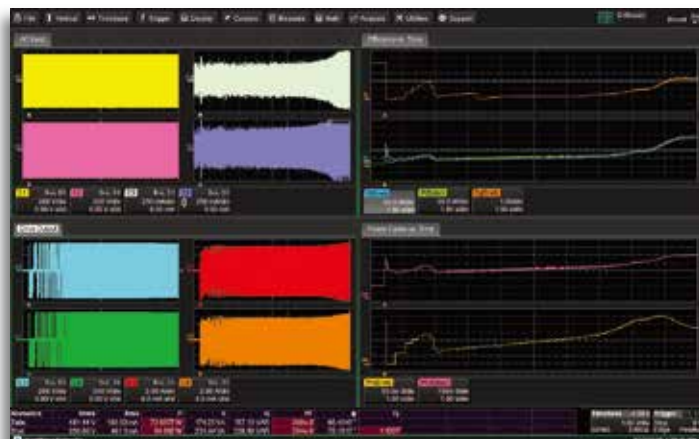
480V驱动采集10秒的波形用于AC输入和驱动输出（左侧）以及右侧显示的功率，效率，和随时间变化的功率因素波形。
